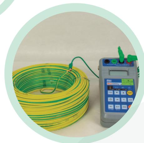
**Ensayo de Resistencia de Aislamiento**
