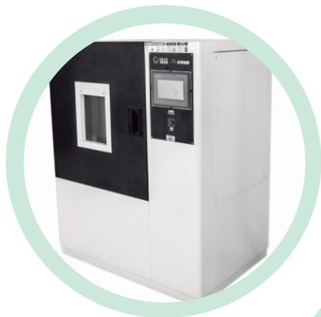
**Ensayo de Envejecimiento Térmico**
