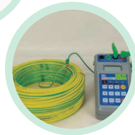
Ensayo de Resistencia de Aislamiento
